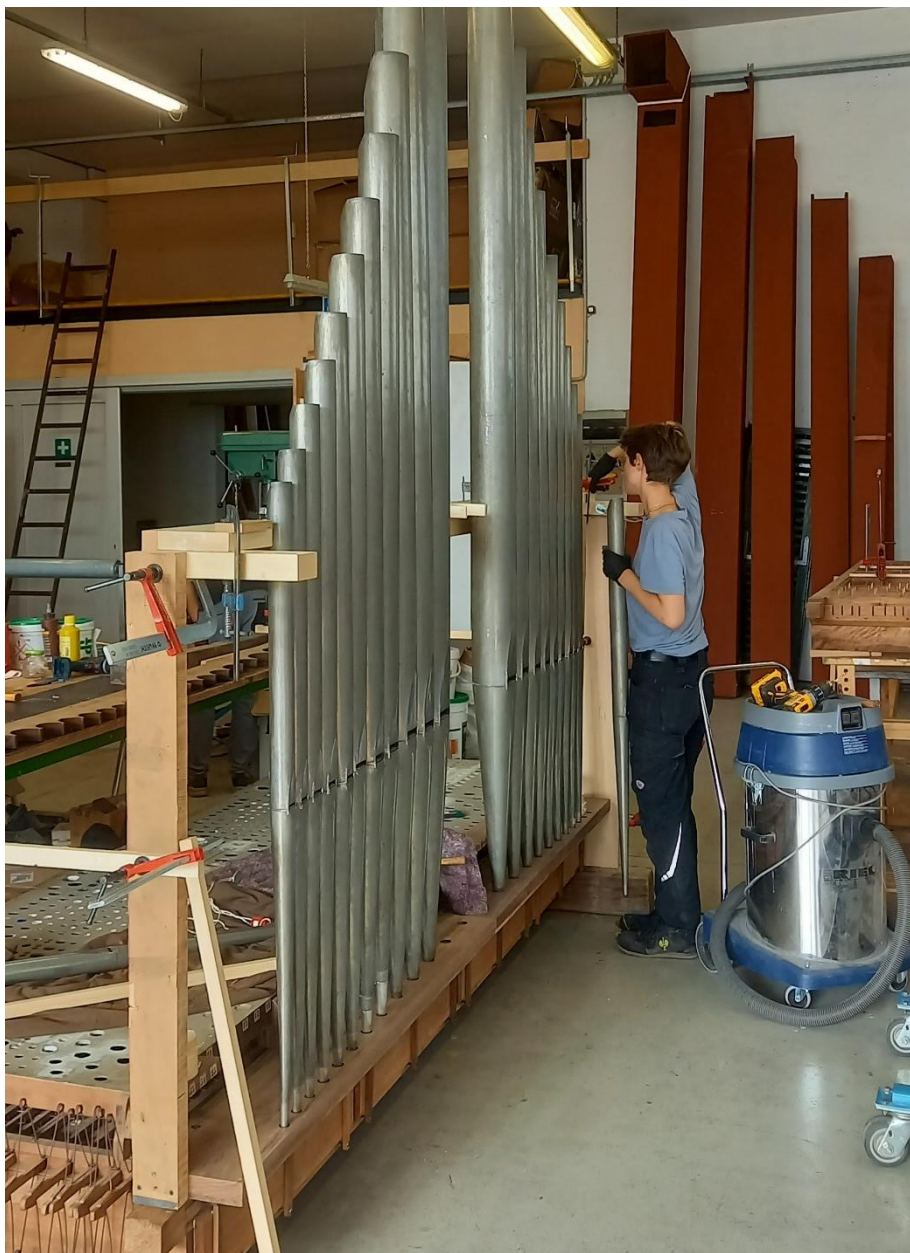
Montaggio canne di facciata in laboratorio
