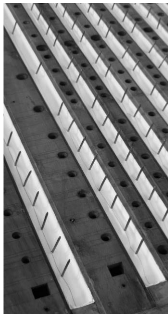
particolare di un somiere "a vento", ma senza borsini
