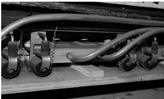
La trasmissione elettropneumatica dell'organo nel Santuario della Madonna del Sasso (1961)
