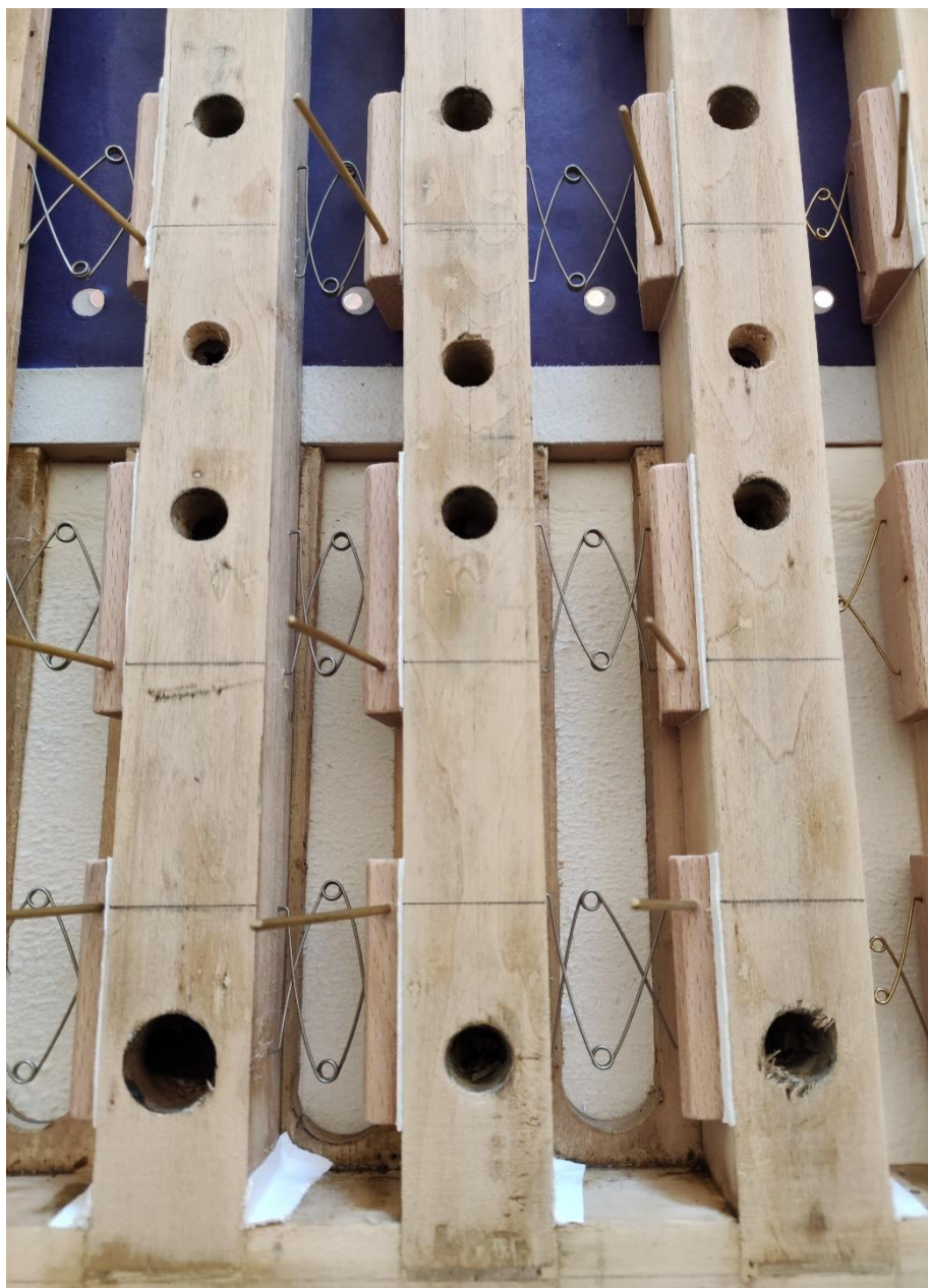
Nuovi ventilabrini nel somiere maestro
