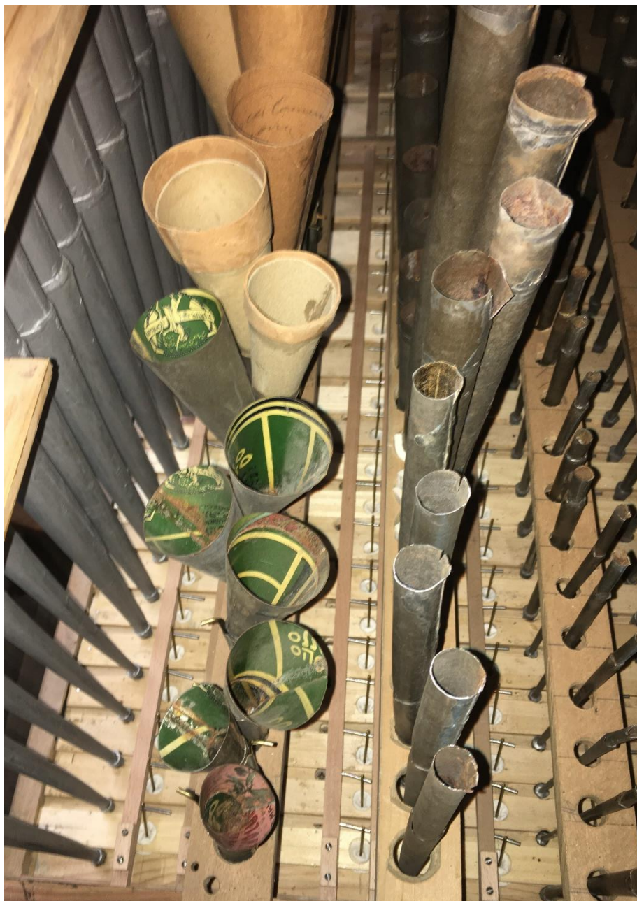
Risuonatori della Tromba ottenuti da latte di Olio Sasso
