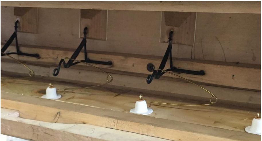
Particolare del somiere dei registri Contrabbasso e Trombone durante il restauro
