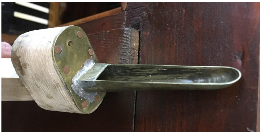
Canaletto in ottone appartenente al Trombone
