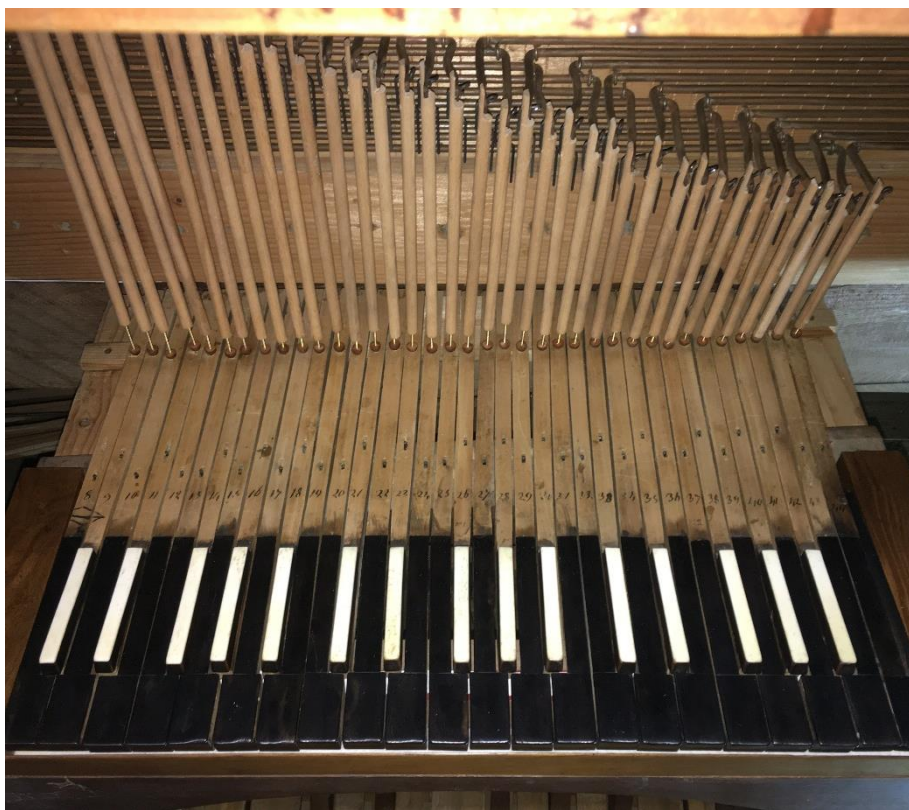
La tastiera con i nuovi pironi regolabili
