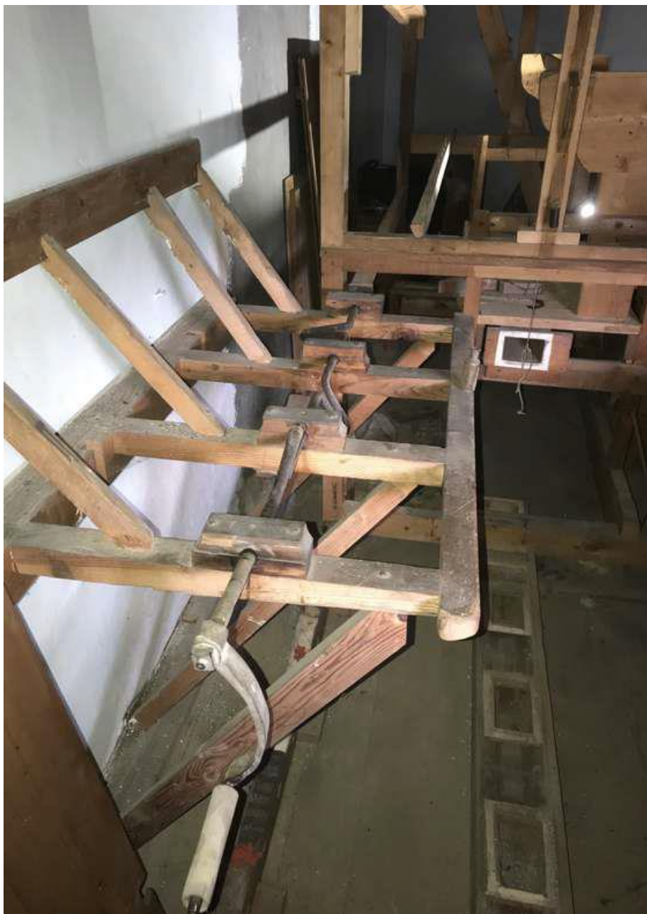
Struttura relativa all'azionamento manuale dei mantici
